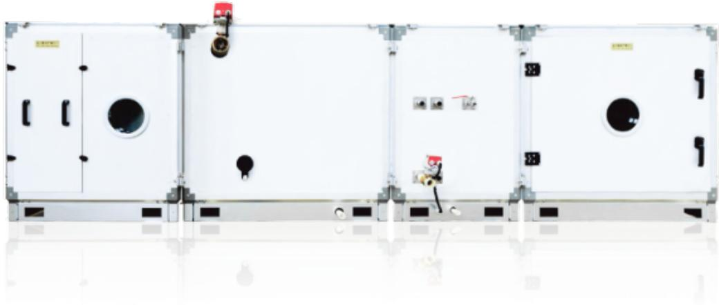
新风送气设备与新风机组(简称新风机)是不同的两种空气设备。那么这两种设备有什么区别呢？新风机组的工作原理是在室外抽取新鲜的空气经过除尘、除湿（或加湿）、降温（或升温）等处理后通过风机送到室内，可以让室内环境达到恒温恒湿的要求。新风机组是一种室内通风换气设备，新风机组把室内污浊的空气排放出去，同时，也将室外的新鲜空气输入室内。新风送气设备控制包括：送风温度控制、送风相对湿度控制、防冻控制、CO<sub>2</sub>浓度控制以及各种联锁内容。如果新风机组要考虑承担室内负荷（如直流式机组），则还要控制室内温度（或室内相对湿度）。新风机主要用于通风，可以为室内提供新鲜的室外空气，这样，人们在室内，即使关闭门窗，也可以呼吸到新鲜干净的空气，有利于人体健康。新风机没有电加热装置与表冷器装置，没有调节室内环境温度的功能。新风机组一般与中央空调配套使用，因为中央空调可以提供新风机组所需要的冷热源，而新风机作为一种室内通风换气设备单独使用。
